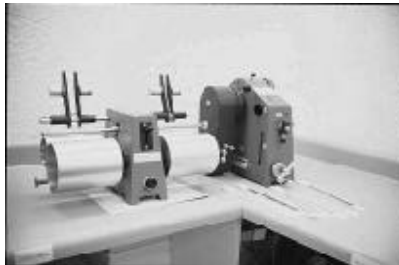
Figura 11. Aparato IGT para prueba de la superficie del papel al desprendimiento.
